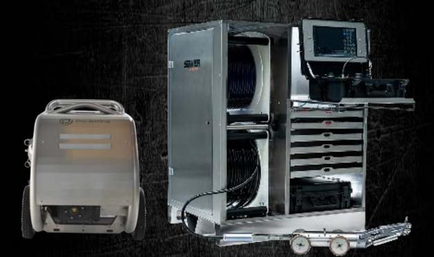
MOBILE CONFIGURATION INSIDE ALUMINUM SHIPPING BOX WITH HA125 CUTTER AND 500BAR (7,250PSI) POWERPACK
